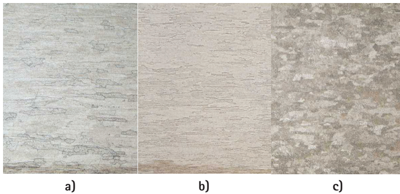
Bild 2: Gefügebilder der 3 Legierungen FKS 16Pt (a), FKS 16PtRh10 (b), FKS 10PtAu5 (c).
