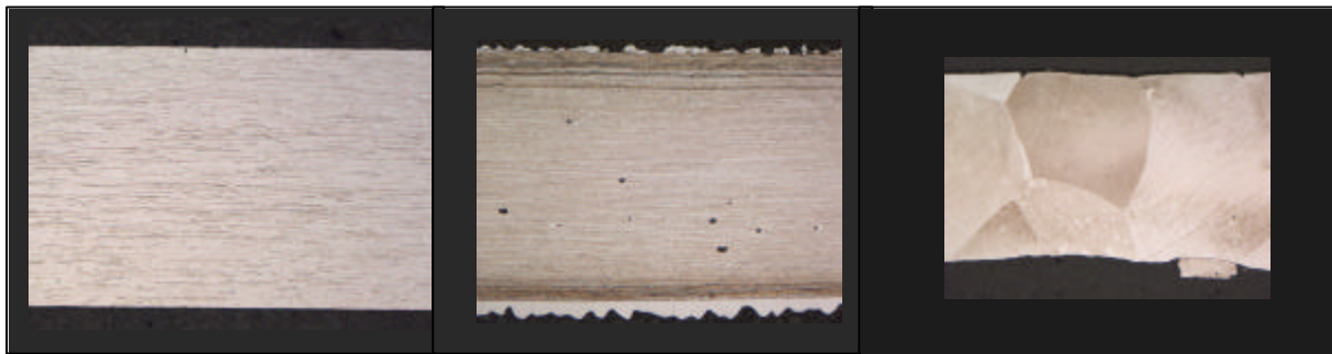
Abbildung 3: Gefügestruktur von FKS 16PtRh10 und PtRh10: a) FKS 16PtRh10 Halbzeugqualität weichgeglüht; b) FKS 16PtRh10 38 Monate bei 1.300°C gealtert, c) PtRh10 weichgeglüht
